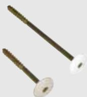
Vis acier protégée contre la rouille avec filetage spécial, pour la fixation sur **support béton**. Perçage Ø 6 mm et une tête Ø 25 mm.
